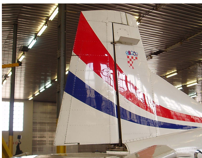
Slika 3.24. Izgled kormila sa stabilizatorom
